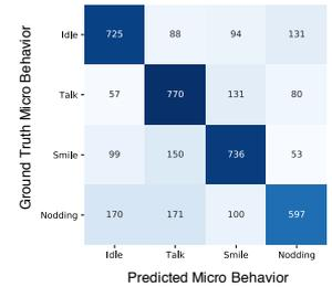
図 6: Talk と Nodding を対象に認識した結果の混同行列 (アンダーサンプリングなし)
