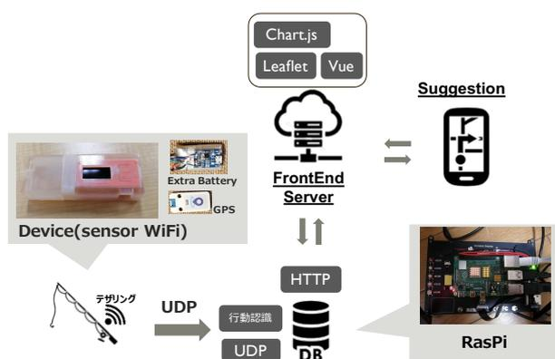
図 1 釣りの CPS の概要図
