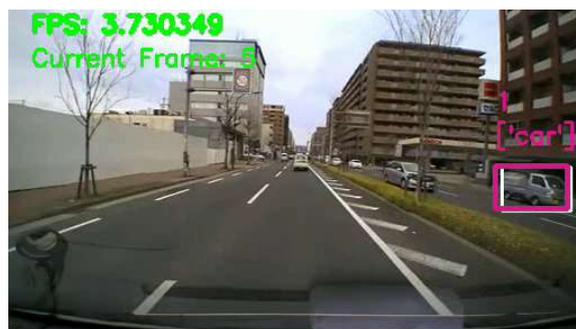
図 3 YOLOv3-tiny による認識
